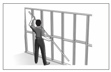
**FIGURE 1 FRAME STRAIGHTNESS**
